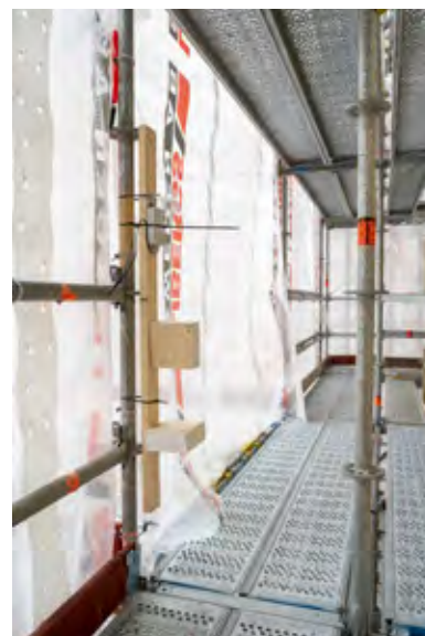
Mätstationer för analys av klimatförhållandet under väderskyddet.
